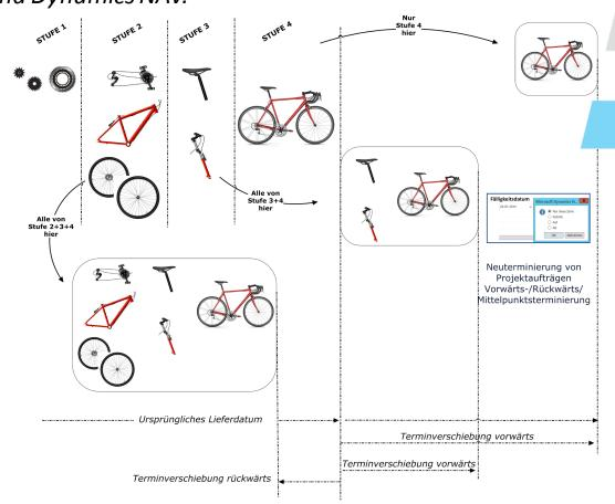
Terminliche Änderungen von Projekt-aufträgen führen zu Neuterminierungen (ggfls. Vorwärts/Rückwärts/ Mittelpunkts-orientiert) des gesamten Auftragsnetzes.
