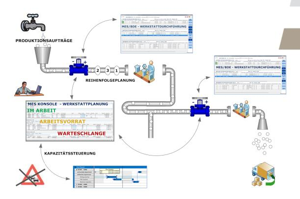
SHOPFLOOR unterstützt die Optimierung von Fertigungsprozessen und basiert auf den Prinzipien optimierter Warteschlangen- und Reihenfolgesteuerung.
